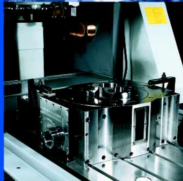
Senkerodierung eines komplexen Werkstückes
